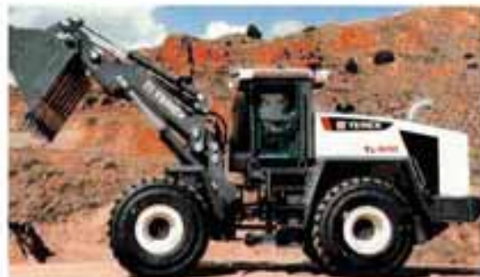
22,3-t-Lader Terex TL 420 mit ZF-Ergopower-Lastschaltgetriebe und ZF-Achsen, Parallel-Kinematik des Hubgerüsts und serienmäßiger Schwingungsdämpfung. Foto: Terex
