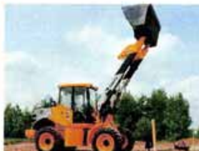
Palazzani PT 72 von A&P Baumaschinen mit doppeltem Teleskop-Hubarm, durch den der 7,5-t-Lader mit 1,1 bis 2 m 3 Schaufelinhalt 4,07 m Ausschütthöhe erreicht. Foto: A&P
